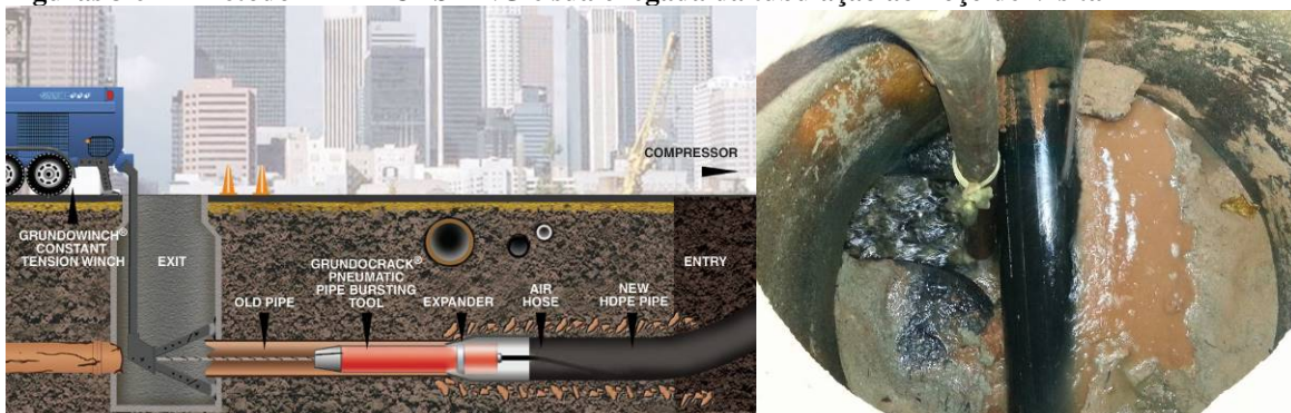
Figuras 3 e 4 - Método PIPE BURSTING e sua chegada da tubulação ao Poço de Visita
