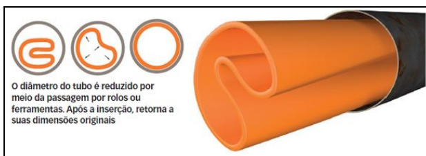
Figura 1 - Método CLOSE-FIT-LINING
